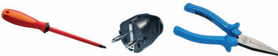
Sl. 2.3 Alati i vodovi presvučeni su plastikom jer je dobar izolator
